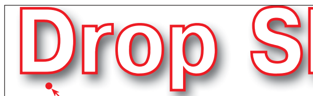
Рисунок 3 Значения цвета тени «обрезаются» при печати на 3-х %. Край будет «резким».
